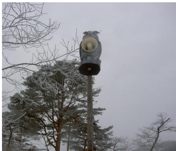
写真8 鳥帽子山公園に設置した電子音式防鳥器 園内に4器設置し、不定期にウソが嫌う鳥の 鳴き声を流している
